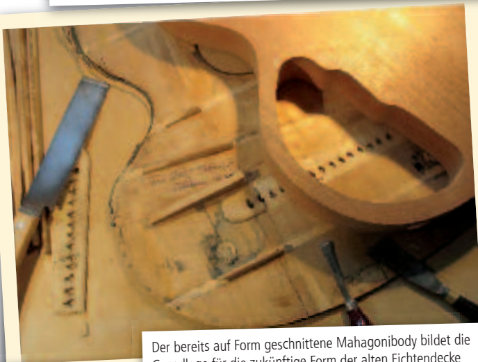
Fundsache Reisinger: An der Unterseite der Fichtendecke wurde die Bebakung und das Gegenlager für die Saitendurchführung teilweise entfernt. Deutlich sichtbar ein Reparaturvermerk von Toni Wolf aus Wien, VII Bezirk im Jänner 1926.
