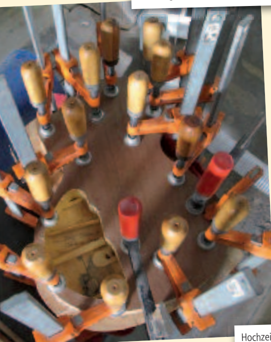
Der bereits auf Form geschnittene Mahagonibody bildet die Grundlage für die zukünftige Form der alten Fichtendecke
