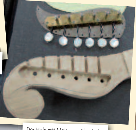
Der Hals mit Makassar Ebenholz Griffbrett entsteht
