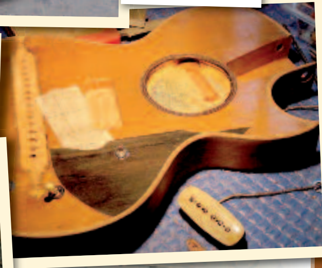
Fertige Fräsungen für die von Michael Spalt veredelten „Bonetop“ Lindy Fralin Pickups
