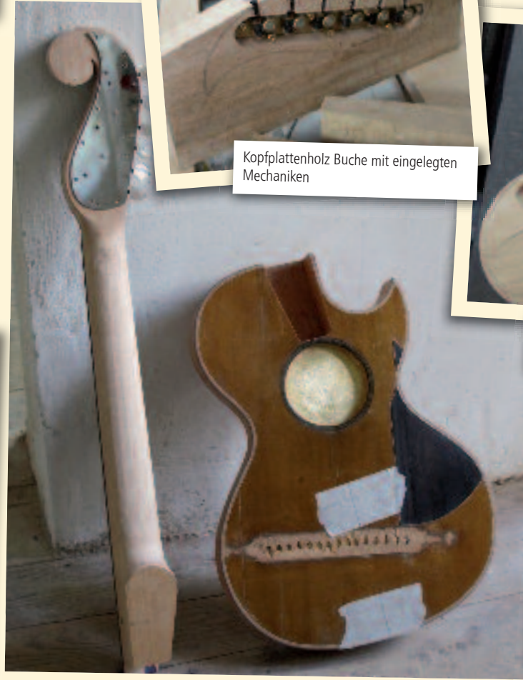
Der Hals mit Makassar Ebenholz Griffbrett entsteht
