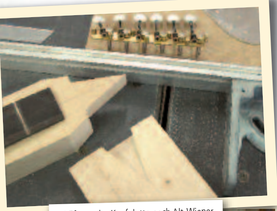
Schäftung der Kopfplatte nach Alt-Wiener Art, traditionell in Buchenholz ausgeführt
