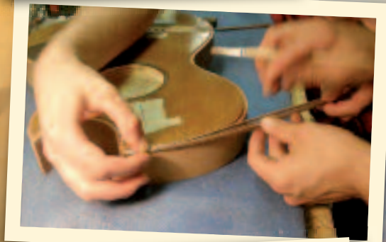
Vergoldung der sichtbaren Untergrundpartien und Anpassung der Decke auf den Mahagonikorpus
