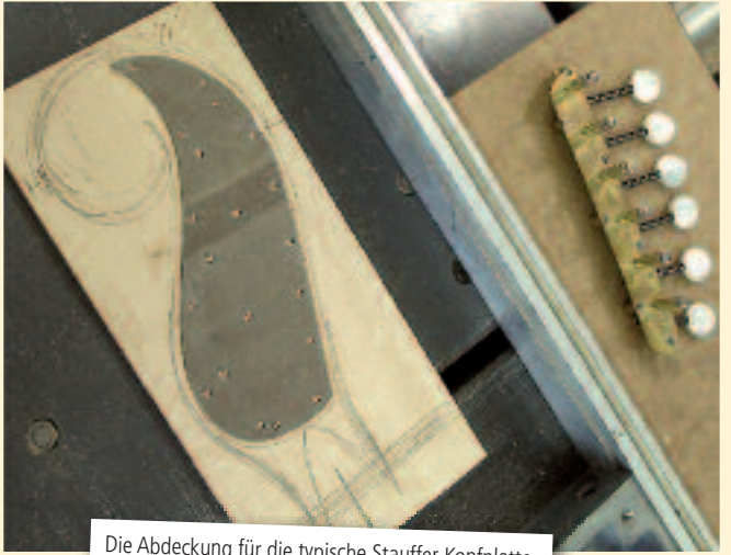
Die Abdeckung für die typische Stauffer Kopfplatte an der Rückseite, hinter der die Markneukirchner Rubner Mechaniken verborgen werden.
